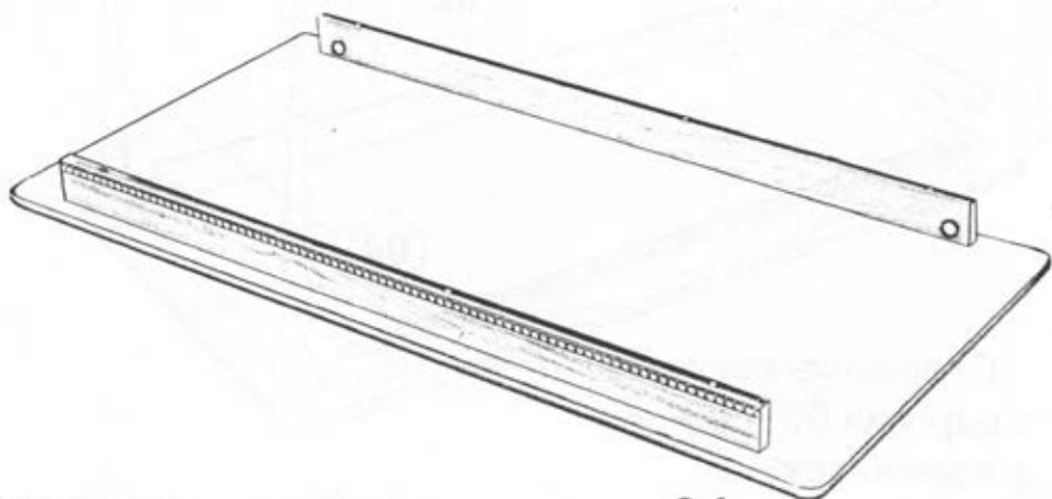
В отверстия с гайкой ножки стола **04** установить винты.
