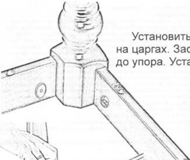
Установить сегмент в отверстия на царгах. Зафиксировать винт до упора. Установить заглушку.
